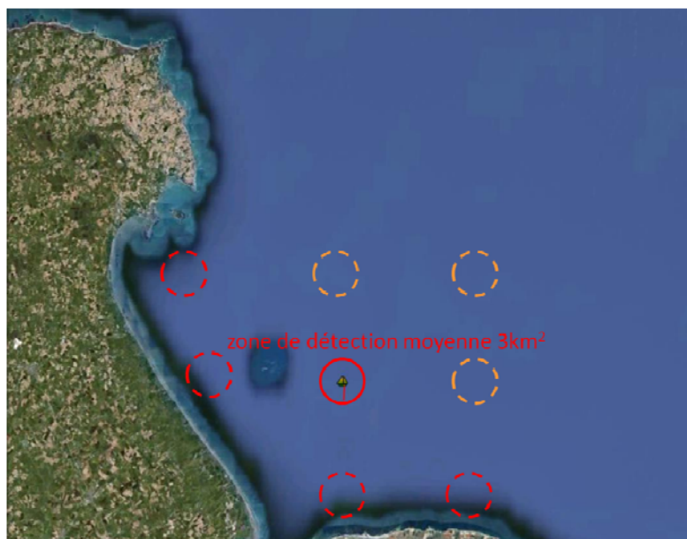
Figure 10 : Proposition d'un réseau d'écouteurs en BSO pour un suivi sur un an. En rouge : zones prioritaires. Cercle rouge solide : position de l'hydrophone dans la phase 1.
